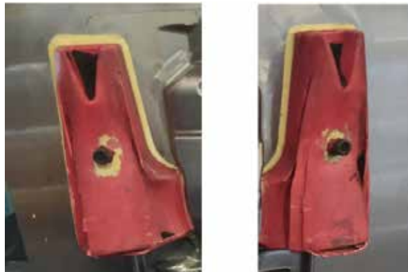
Resim 4 : PLA malzemesi kullanılarak üretilen besleyici kalıplama denemesi
