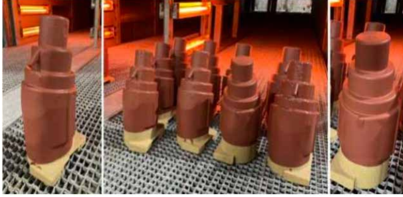
Resim 4 : Su bazlı boya ile yüzeyi kaplanan maça
