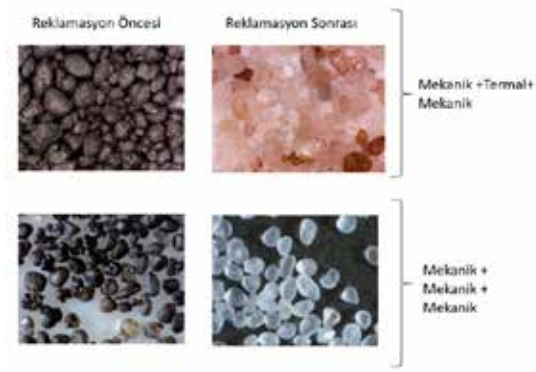
Şekil 5: Atık Kalıp Kumunun Reklamasyonu Kum Mikroskop Görüntüleri
