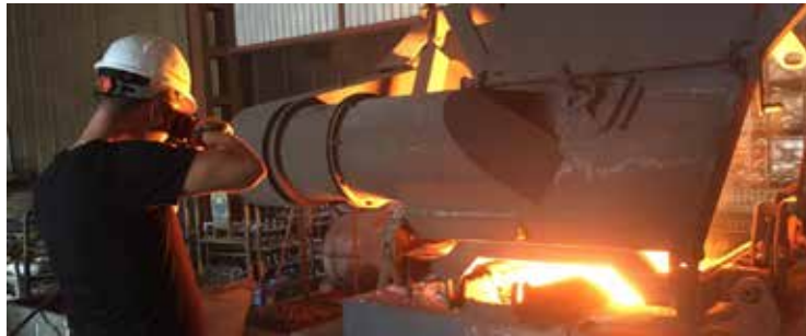
Şekil 12 : Taşınabilir Optik Pirometre ile ölçüm
