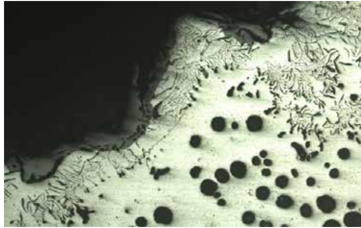
Şekil 8: Balık gözü parçasının mikroyapı görüntüsü (100 büyütme).
