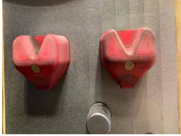
Resim 5 : ABS malzemesi kullanılarak üretilen besleyici kalıplama denemesi
