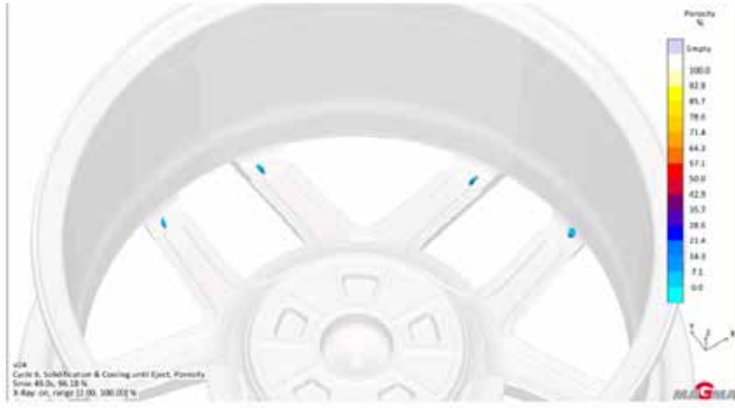
Şekil 13 : 9,5x20" jantı MAGMA simülasyonu sonucu porozite yoğunluğu öngörülen bölgeler
