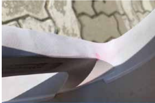
Şekil 19 : 8,5X19" jantı dinamik radyal deneyi sonucu meydana gelen çatlak
