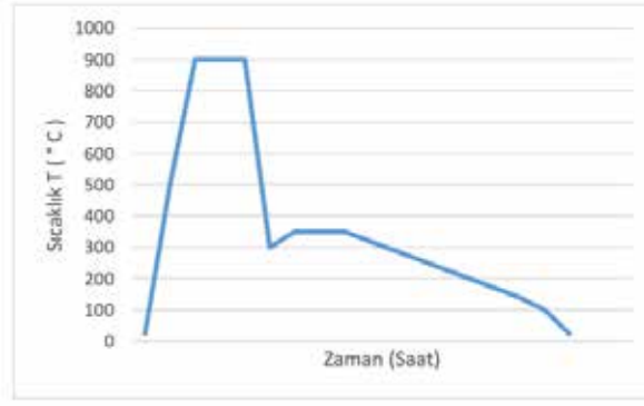
Resim 1: Uygulanan Östempereleme ısıl işleminin şematik gösterimi.
