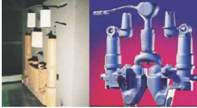
Şekil 1: Sfero Döküm parçasına doğrudan döküm ünitesi ve besleyici gömleklerin uygulanması
