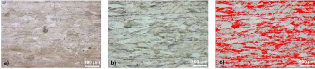
Şekil 4: Deformasyon öncesi (a), deformasyon sonrası (b) ve ImageJ analizi ile martensitik fazın tanımlandığı optik mikroskop görüntüleri (c)
