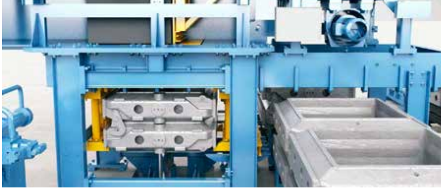
Resim 8 : Kalıp Bozma İstasyonu
