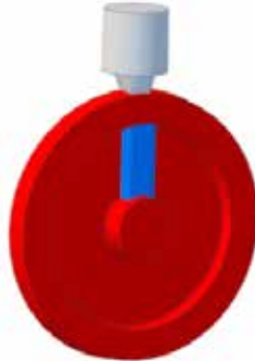
Şekil 2: Tipik bir disk dökümünde merkezi kütleye doğru bir besleyici yolu oluşturmak için metal dolgu uygulaması
