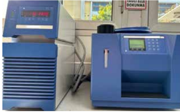
Şekil 3 : Çukurova Kimya Endüstrisi A.Ş.'de bulunan kalorimetre cihazı.
