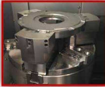
Resim 6: 20 nolu operasyon (Dıştan içe doğru ve aşağı doğru birlikte sıkma)
