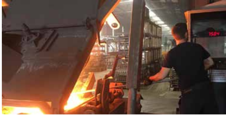
Şekil 11 : Daldırma Tip Kartuşlu Termokupl ile ölçüm
