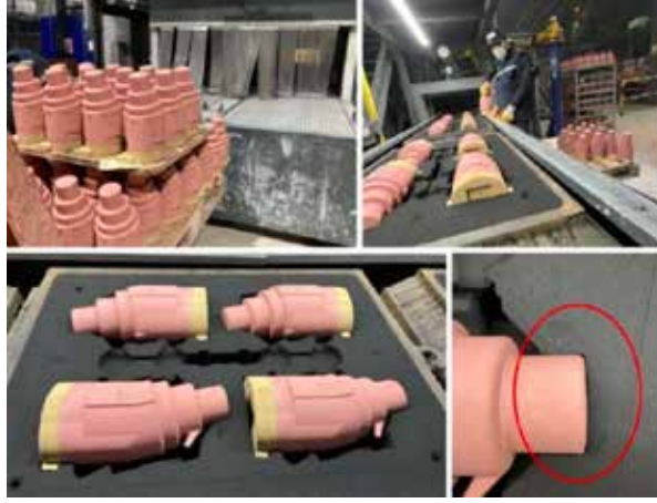
Resim 6 : Maçanın kalıplama hattındaki görüntüsü
