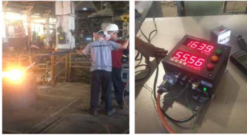
Şekil 4: İndüksiyon fırınlarında sıcaklık ve oksijen seviyesi ölçümleri
