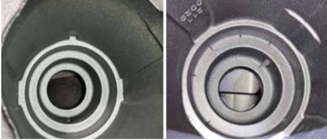
Resim 7 : Su bazlı ve Alkol bazlı maçanın döküm sonuçları
