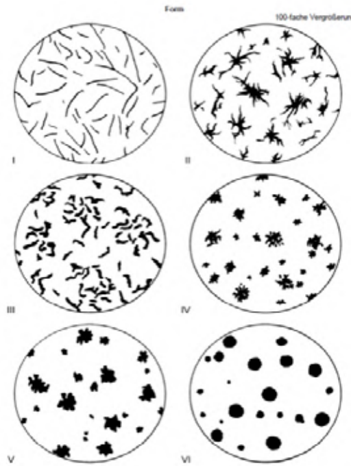
Resim 2: DIN-EN 9445-1:2008 standardına göre dökme demirlerin sınıflandırılması I) Lamel grafitli dökme demir III) Kompakt grafitli dökme demir VI) Küresel grafitli dökme demir
