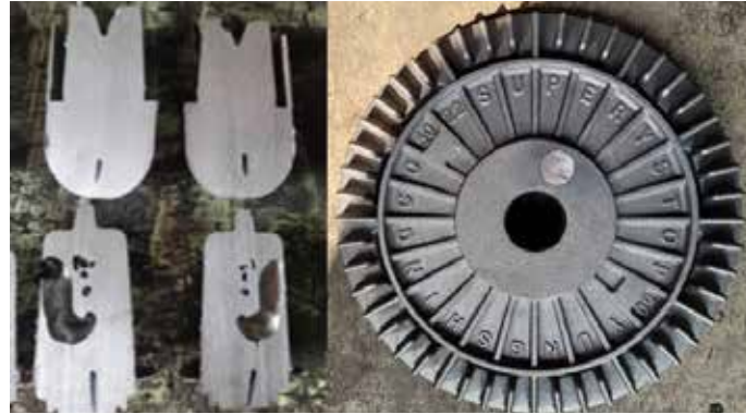
Şekil 12: a+b. Besleyicinin kırılmasından sonra besleyicilerin ve parçanın kesit görüntüleri
