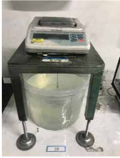
Şekil 1 : Arşimet Prensibine Dayalı Yoğunluk Ölçüm Cihazı
