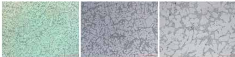
Şekil 12 Isıl işlemlili Göbek 25x 50x 100x mikro yapı
