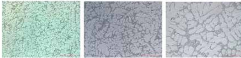
Şekil 11 Isıl işlemlili Kol 25x 50x 100x mikro yapı
