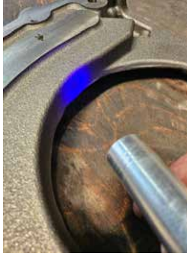
Şekil 3: UV/Mor Işık ile Parça Kontrolü
