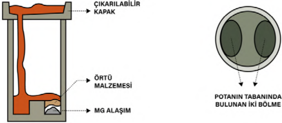
Resim 8: Tandış pota Yöntemi (Lerner and Pantelev ,2003)
