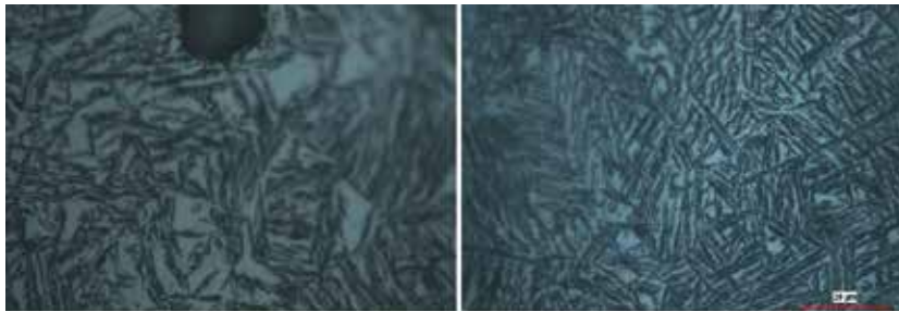
Şekil 3 : Östemperlenmiş numunelerin optik mikroskop görüntüleri a)Standart Numune b) Bakırlı Numune
