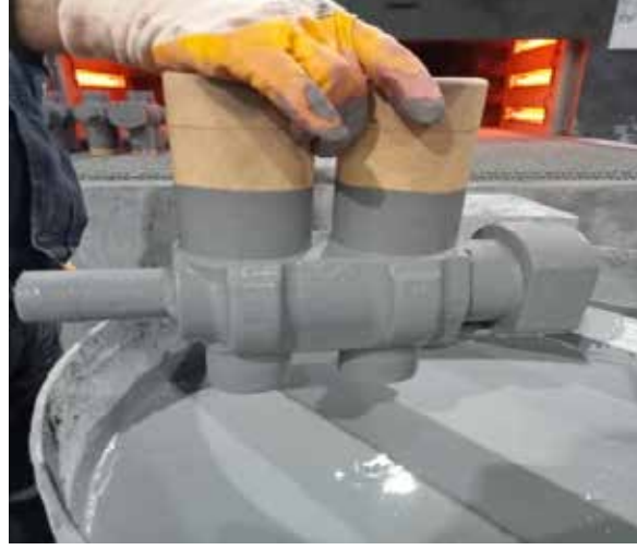
Resim 3 : Daldırma yöntemi ile boyanan maça
